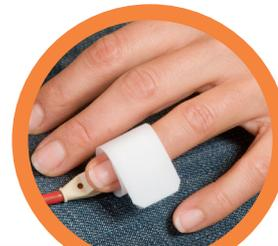
\*MULTISENSOR MISST HAUTLEITWERT, PULSFREQUENZ UND TEMPERATUR
